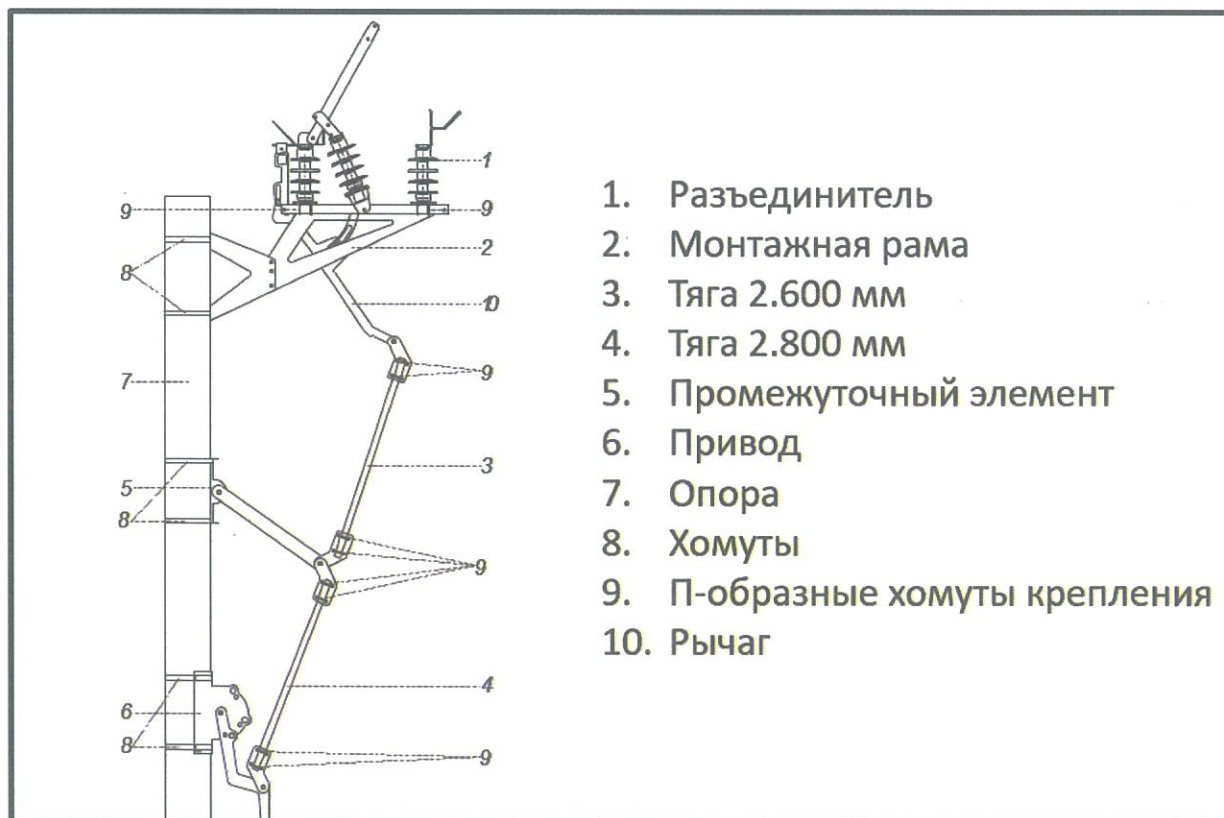
Рис. 1. Схема монтажа разъединителя.
