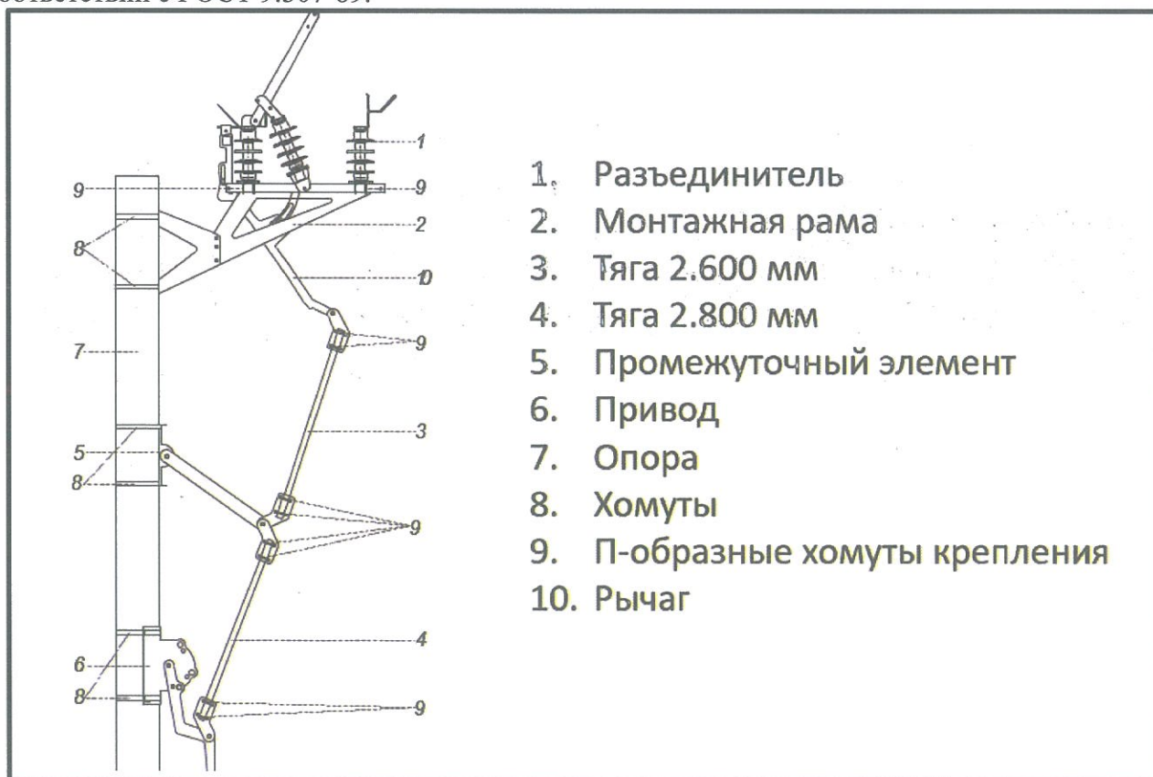
Рис. 1. Схема монтажа разъединителя.
